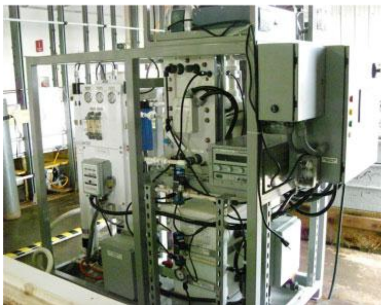
图：E-CEM 碳捕获装置
