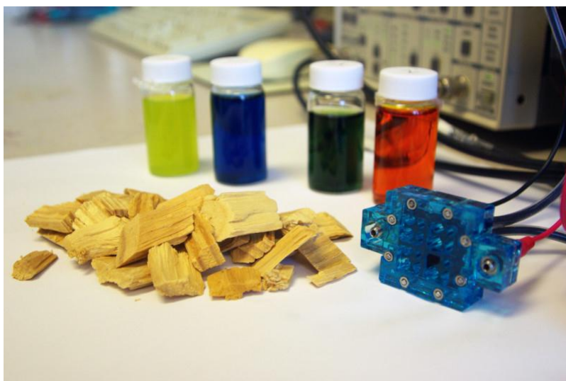
图片：太阳能诱导的直接使用生物质发电的混合燃料电池。这种燃料电池依赖于 POM 催化剂(小瓶中所示)，当与光发生反应，它改变了颜色。
